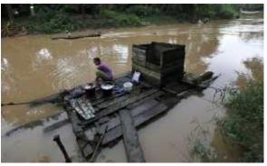
Setiap batang terdiri dari enam batang kayu yang disusun secara berjajar, yaitu tiga batang sebelah luar dan tiga batang sebelah dalam. Sedangkan batang yang terbuat dari bambu terdiri paling sedikit 20 batang bambu yang disusun berjajar.
